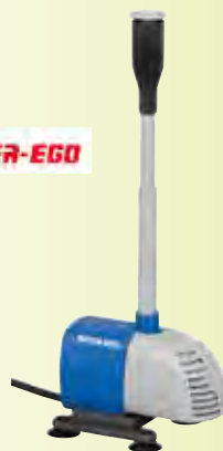
BOMBAS DE FUENTE BFS-14 SUPER EGO Caudal 900 litros/hora. Potencia 18W. Cable 10 m. Altura máxima: 0,6 metros. Profundidad máx. 3 m.
