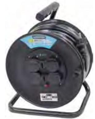
ENROLLACABLE 50M, MADER® tapa de goma . protección para niños.» antihumedad. 4 tomas con seguridad. Sección: 3G x 1,5mm 2 . Aislamiento: IP44 Cable: H05VV-F Toma Eléctrica: 4
